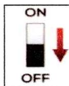
Aislar o cortar el flujo de energía o energías de un equipo, máquina, proceso o sistema mediante la desactivación del interruptor, dispositivo de control de flujo o colocación de barreras físicas para impedir el suministro o retorno de las energías. En los sistemas con energías remanentes, previamente se debe liberar dichas energías.
